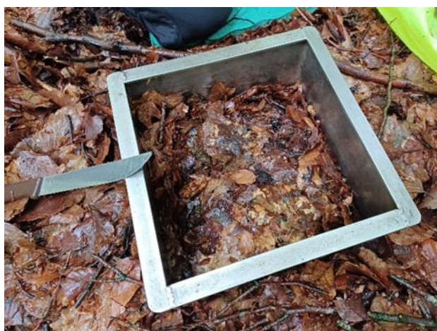
rys. 3. Ramka do poboru poziomów organicznych
